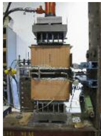
Figuur 7: Proef voor de bepaling van de schuifsterkte
