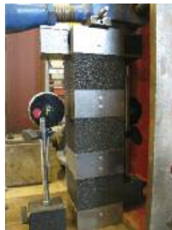
Figuur 4: Kruipproeven op FOAMGLAS® PERINSUL-blokken
